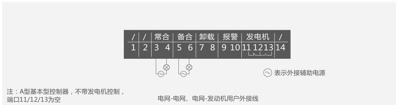
控制器侧端接线端口 II
