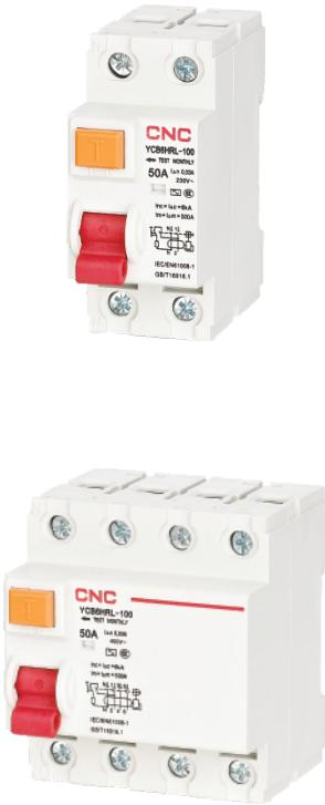
YCB6HRL-100剩余电流动作断路器(不带过电流保护)适用于交流50Hz，额定电压两极230V，四极400V，额定电流至100A线路中，当人身触电或电网泄漏电流超过规定值时，剩余电流动作断路器能在极短的时间内迅速切断故障电源，保护人身及用电设备的安全，亦可作为线路的不频繁转换起动之用。
